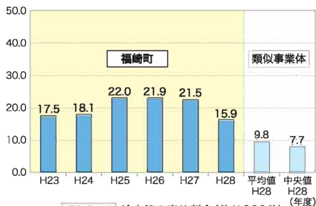
図3.3-15 給水管の事故割合 (件/1000件)
